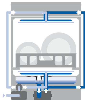
Vattentillförsel med tanksystem
